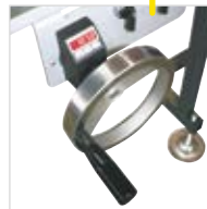
LED-DIGITALANZEIGE AN HANDRADVERSTELLUNG
