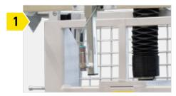
Die berührungslose, ultraschallgesteuerte Elektronik registriert ein Auf- oder Abstapeln und gleicht den entstandenen Unterschied aus.
