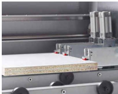
Sicheres Klemmen von Plattenpaketen und einzelnen, kleinen Plattenmaterialien
