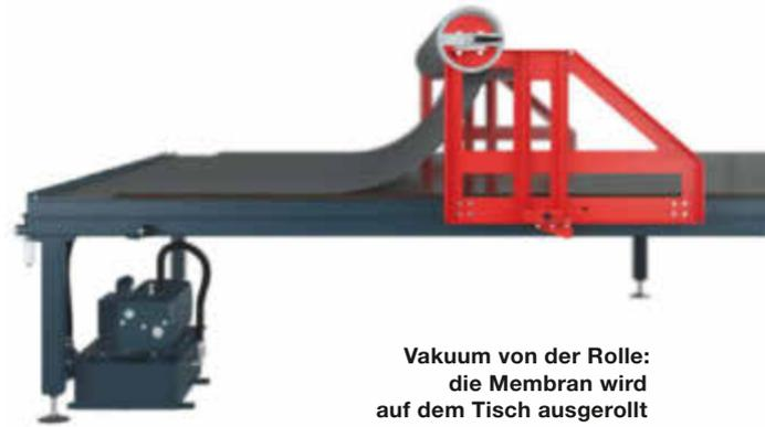
Vakuum von der Rolle: die Membran wird auf dem Tisch ausgerollt
