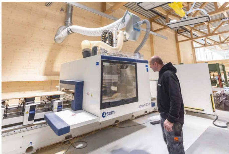
Bei den 28 Bearbeitungsmaschinen achtete Scheuch LIGNO auf eine schlichte und für die Halle optimale Rohrführung.
