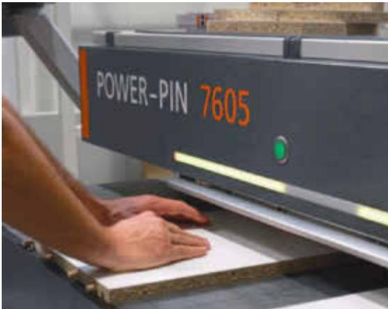
Nesting und dann? Automatisches Dübelbohren und -eintreiben auf der Power-Pin 7605 Dynamic
