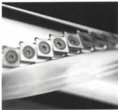
**dual 51:** Silent-Power® Spiralmesser-Hobelwelle – Speziell entwickelte Hartmetall-Schneiden
