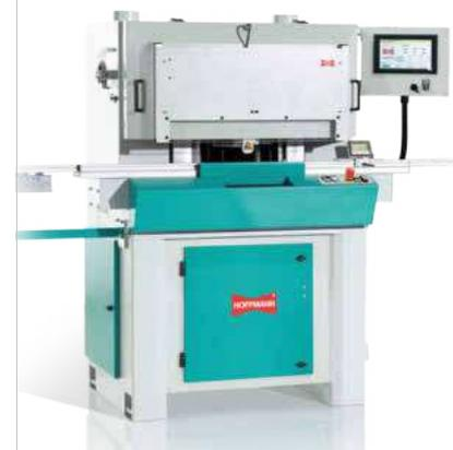
Automatische Doppelgehrungssäge mit integrierten Fräseinheiten zur Herstellung von Schwalbennuten.
