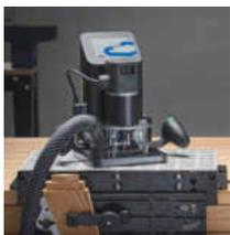
Mit der Workstation und Origin lassen sich akkurate stirnseitige Verbindungen fräsen
