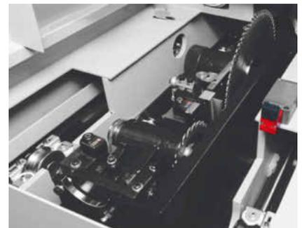
Die Schnitthöhe wird manuell, pneumatisch oder elektromotorisch eingestellt
