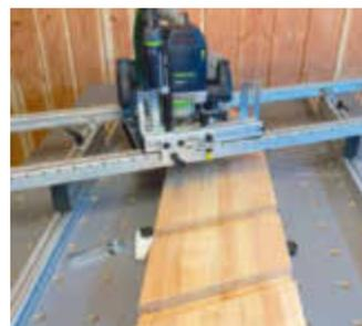
**Präzise: mit der Oberfräse formatieren bzw. Nuten fräsen**
