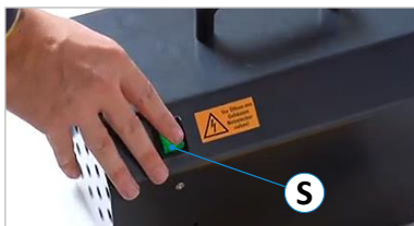
Figure 11 : interrupteur de pompe à vide
