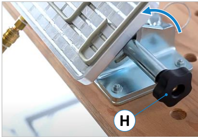
Figure 17 : pivoter le plateau de serrage
