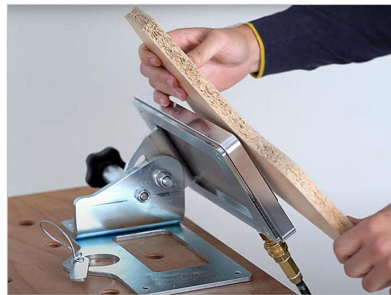
Figure 19 : retirer la pièce à usiner
