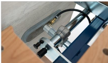
Figure 8 : unité de serrage par le vide
