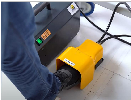
Figure 18 : commande au pied pour desserrage
