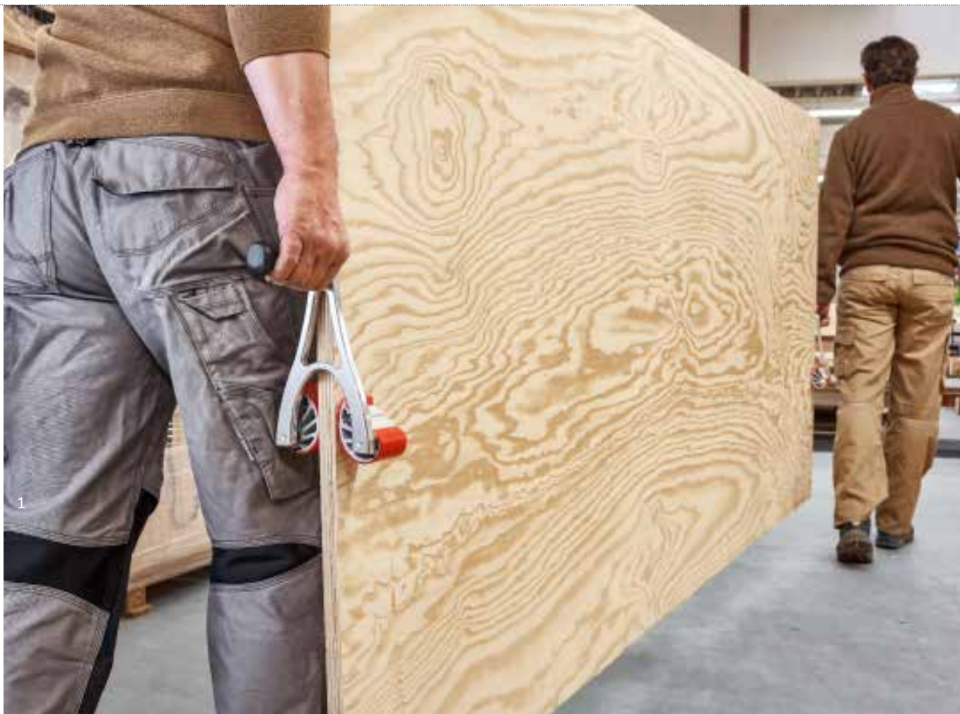
Eine oft unvermeidliche Aufgabe: Das Plattenhandling (im Bild mit Hilfe eines Plattenträgers).
