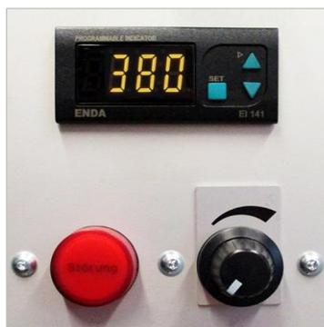
Abbildung 42: Drehzahlregulierung
