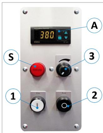
Abbildung 21: Schalter bei stufenloser Drehzahl
