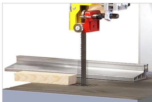
Abbildung 33: Anschlagseinstellung flach
