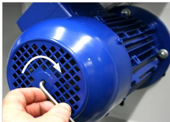
Abbildung 58: Motorbremse nachjustieren
