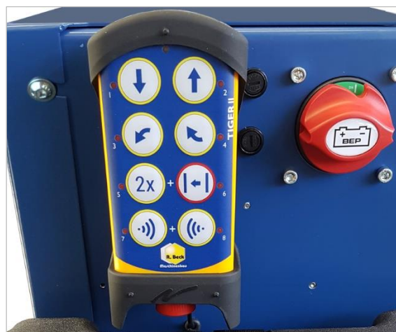
Abbildung 10: Ladestation neben dem Hauptschalter
