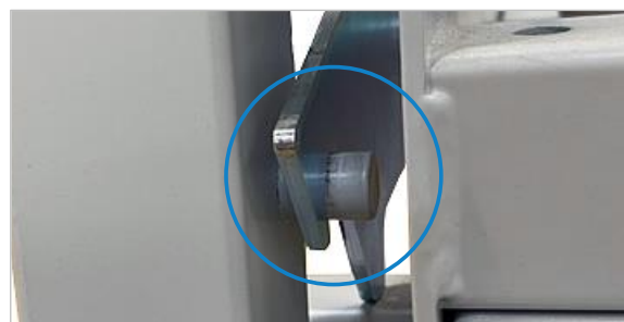
Figure 10: le cadre pivotant est enclenché verticalement
