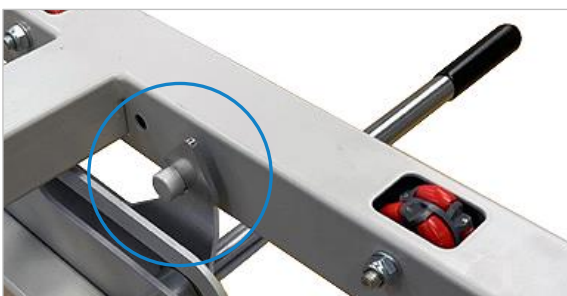
Figure 9: le cadre pivotant est enclenché horizontalement
