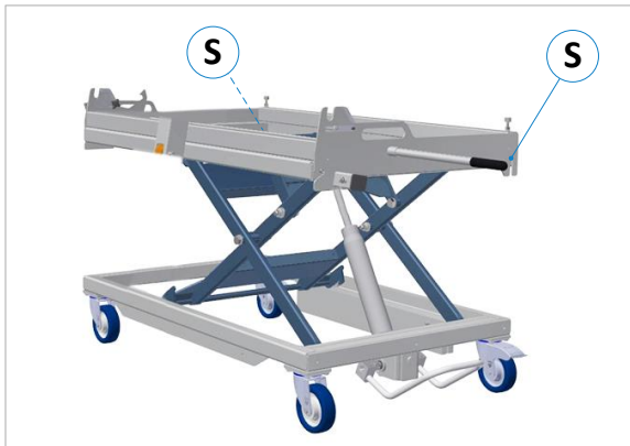
Figure 7 : démonter le cadre de support
