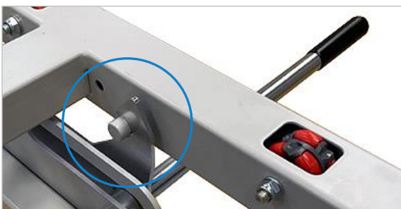
Abbildung 9: Schwenkrahmen ist horizontal eingerastet
