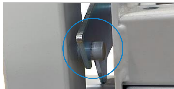
Abbildung 10: Schwenkrahmen ist vertikal eingerastet
