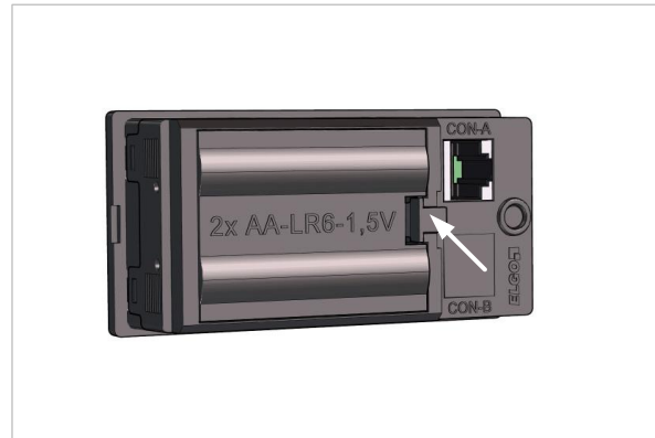
Figure 14 : compartiment à piles à l'arrière
