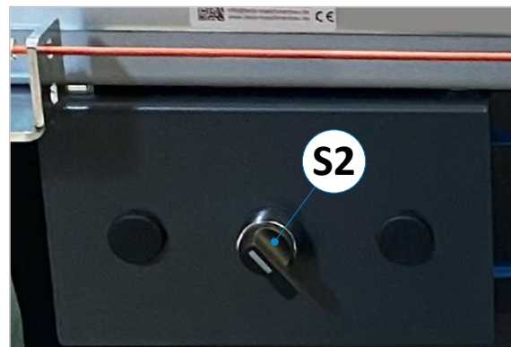
Figure 19 : commutateur de course libre (option BELG 06)
