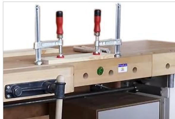
Abbildung 14: Vertikalzwingen - Anwendungsbeispiele
