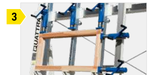
Die Rahmenpresseeinrichtung (optional wählbar) verfügt über ein durchgehendes linkes Widerlager und einen Schiebeschlitten, der im 50 mm Raster mit 2 Winkelgetrieben arretiert werden kann.
