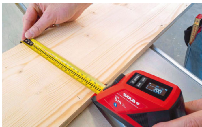
/ Bis zu 5 m misst das digitale Rollbandmaß Cito. Die Messwerte werden digital am Display angezeigt und sind auch im Dunkeln und aus jedem Blickwinkel ablesbar.
